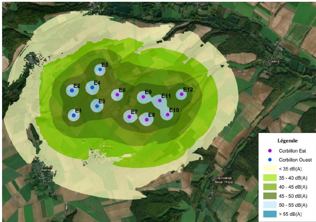
Carte 55 : Isozones à une hauteur de 2 m du sol de la contribution des éoliennes Configuration Siemens Gamesa pour une vitesse standardisée de 10 m/s et une direction Nord-Est - Source : EREA Ingénierie
