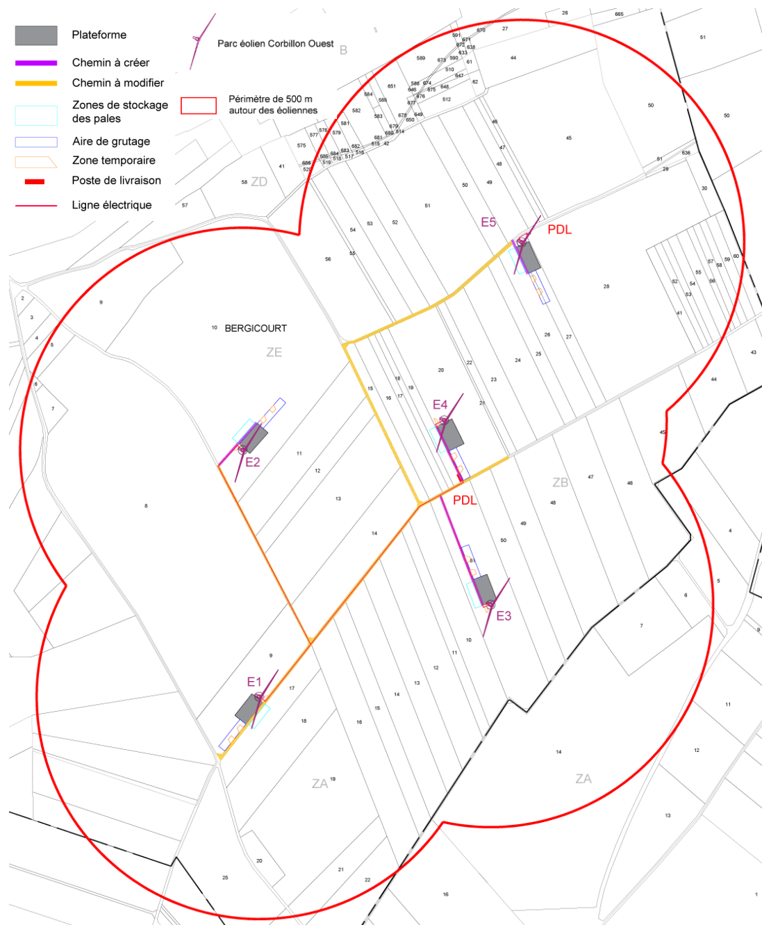
Carte 5 : Chemin à créer et à modifier pour le parc éolien de Corbillon-Ouest – Source : Ventelys Energies Partagées
